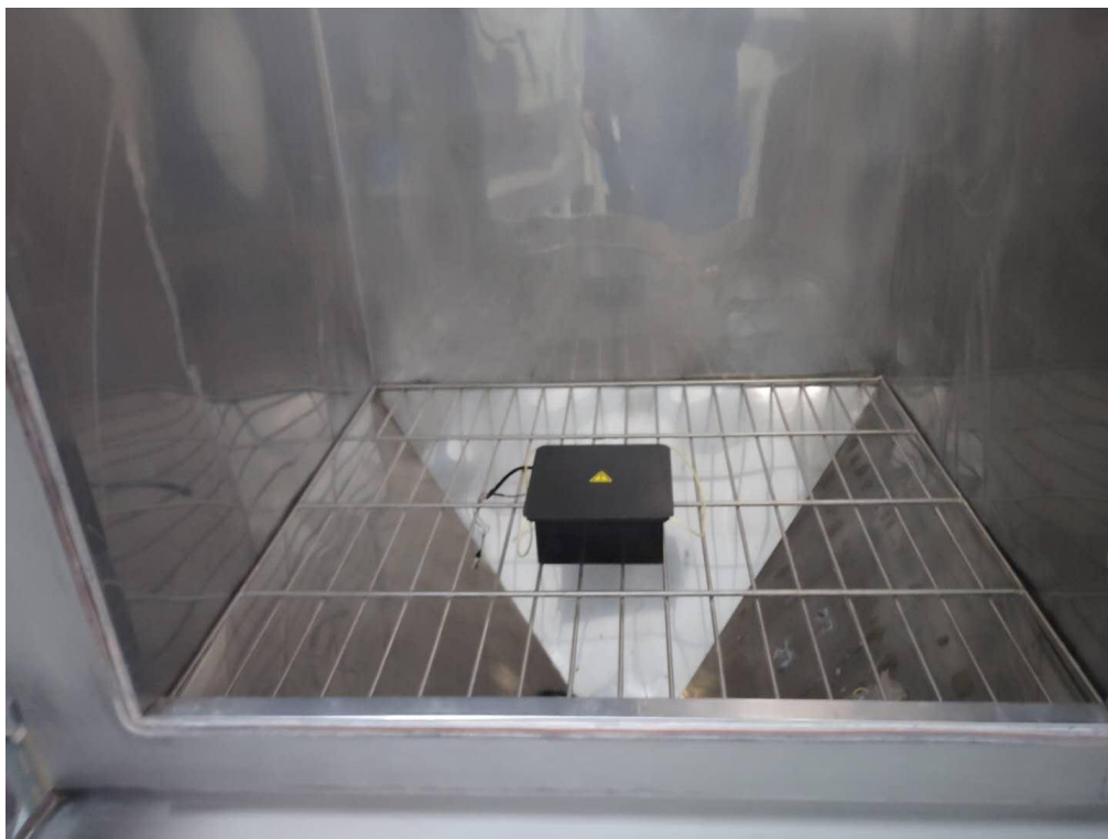
EUT-1 在沙尘试验箱中固定照片
