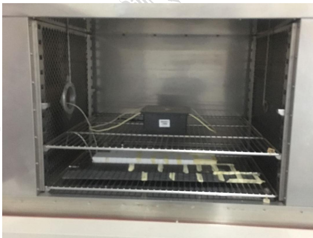
EUT-1 在温度变化试验箱中固定照片
