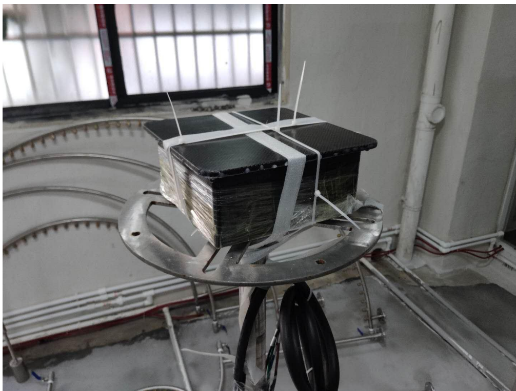
EUT-2 在防水试验装置上固定照片
